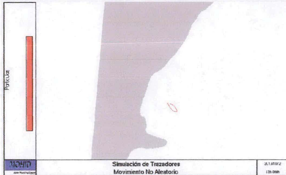
Figura 6.7: Trayectoria realizada por el posible futuro difusor ubicado en el Punto 7 del Emisario Central.
